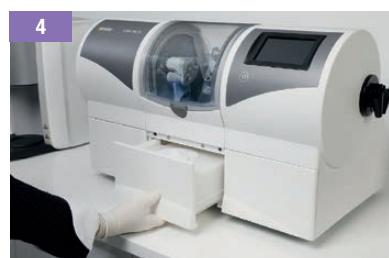
4 Uklonite spremnik za rashladenu vodu za staklokeramiku i instalirajte spremnik vode za pranje.
