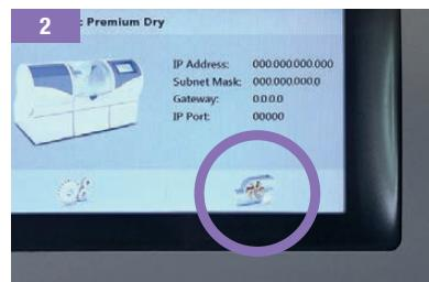
2 Postavite spremnik s rashlađenom vodom za staklokeramiku. Pritisnite gumb na zaslonu kako bi otklonili nepotrebni prah koji se nalazi unutar komore za glodanje.
