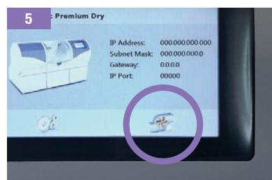
5 Pritisnite Pump tipku na zaslonu za pranje unutrašnjosti pumpe.
