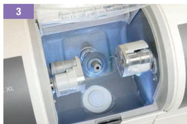
3 Zatim temeljito isperite ostatke glodanja iz filtera komore za glodanje i mljeveni prah iz komornog filtera.
