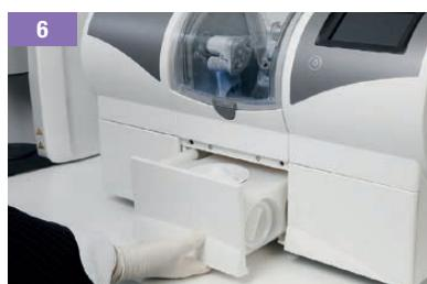
6 Skinite spremnik vode za pranje i instalirajte cirkonijev spremnik za hladnu vodu. Zatim prebacite uredaj na mokri način glodanja prije početka glodanja.
